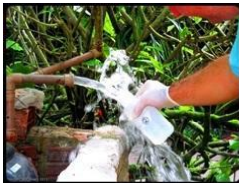
Figura 3 – Água subterrânea coletada com auxílio de uma bomba.
