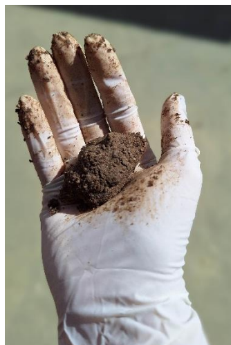
Figura 7. Monitoramento da umidade através do Método empírico da bolota
