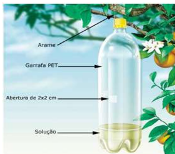
Figura 6 - Desenho esquemático do Frasco caça-mosca
