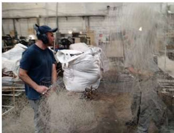
Figura 10 – Reprocessamento da Poliamida-6 (nylon) a partir de redes fantasmas removidas do mar.
