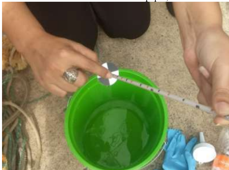
Figura 2. Aferição da turbidez da água com o disco de Secchi do Ecokit II.
