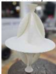
Figura 4 - Modelo I versão 3 pás impresso em 3D
