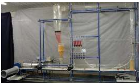
Figura 3 – Descritivo da unidade experimental de transportador pneumático. 1) Duto de sucção de ar atmosférico com 217 mm; 2) ventilador centrífugo com pás parcialmente abertas; 3) motor elétrico de corrente alternada de 3 kW; 4) conexão de seção quadrada para circular; 5) inversor de frequência do motor elétrico; 6) interruptor de controle de rotação da válvula rotativa; 7) tubo de aço carbono com diâmetro interno de 117 mm com endireitamento; 8) silo alimentador de sólidos e válvula rotativa; 9) tubo de acrílico com diâmetro interno de 117 mm; 10) banco de manômetros de tubo em forma de U com água; 11) anéis piezométricos para leituras de pressão em T a montante e a jusante; 12) T com flanges; 13) acoplamento de flange para dispositivo coletor; 14) ciclone receptor para silo. [10]
