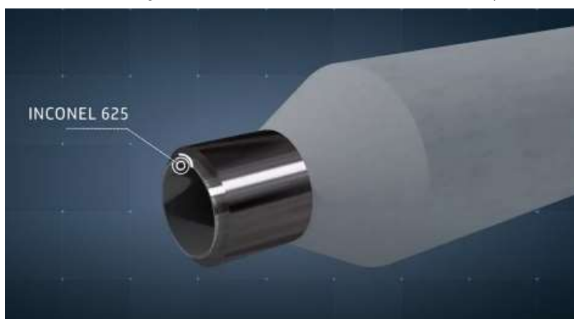
Figura 1. Tubo de aço carbono com revestimento interno (Inconel 625).
