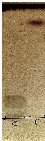
Figura 3: Análise de compostos fenólicos por CCD. A amostra corresponde à linha 'C'. A linha 'P' corresponde ao padrão de ácido gálico.
