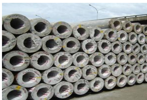
Figura 4: Estacas de concreto armado e seção circular
