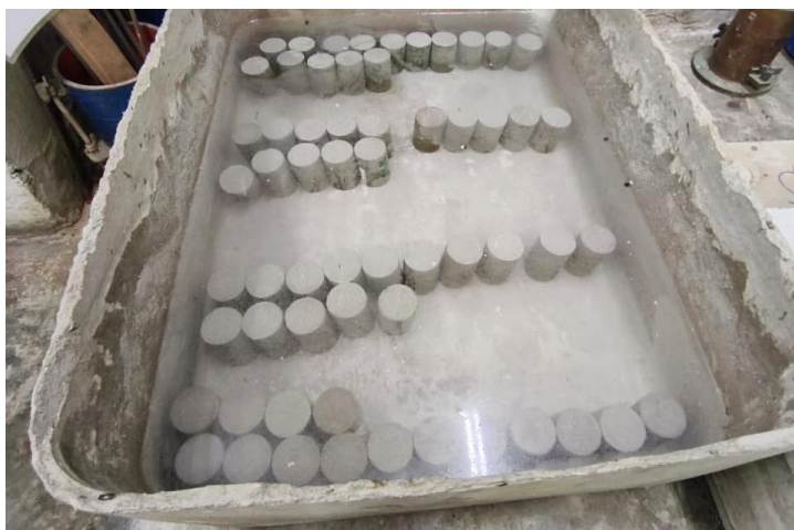
Figura 2: Corpos de prova em tanque para cura submersa.
