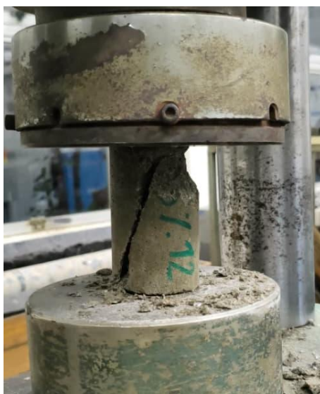
Figura 6: Ruptura cisalhada lateral
