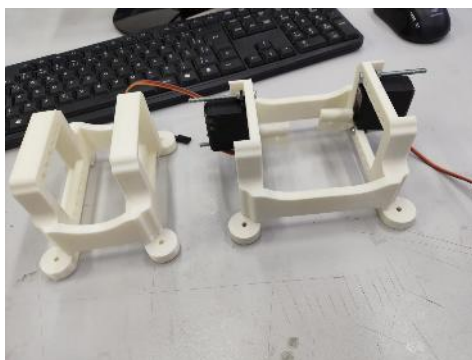
Figura 3: Comparação entre encapsulamentos atual (direita) e anterior (esquerda).
