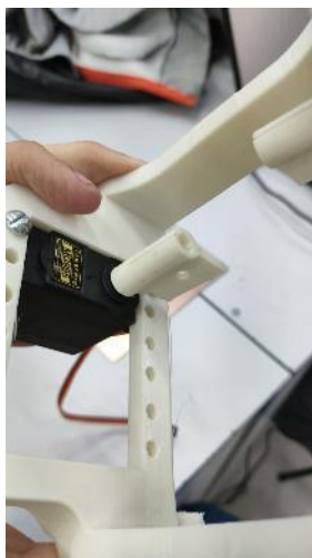
Figura 4: Suporte 3D da palheta fixado no servomotor.
