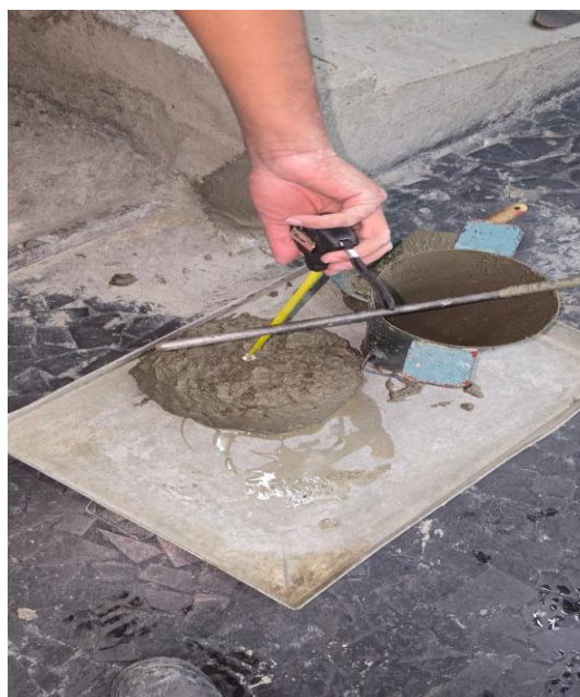
Figura 1: Ensaio Slump Test,
