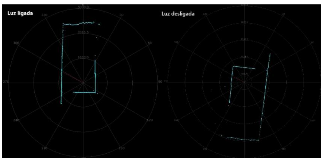
Figura 6: Comparação entre medição com luz ligada (esquerda) e luz desligada (direita) em um ambiente residencial interno
