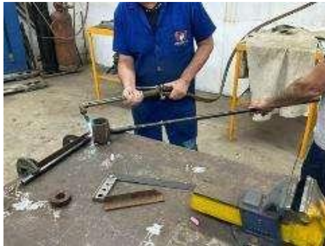
Figura 9 – Utilização de calor com um gabarito para as curvas
