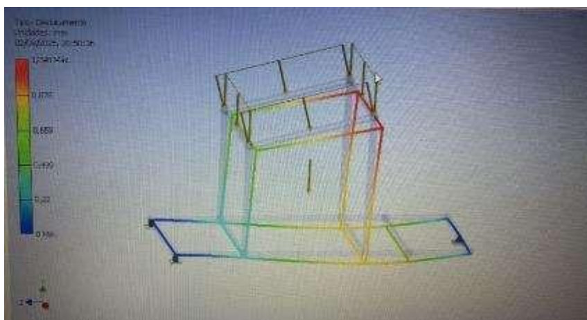
Figura 11 – Simulação Estrutural no Autodesk Inventor
