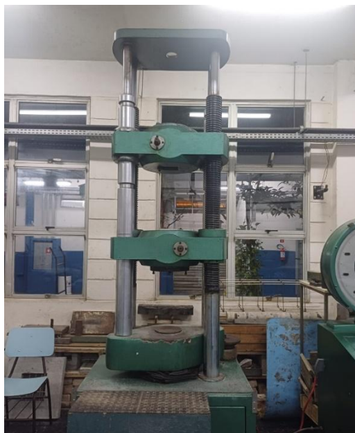
Figura 4 Prensa hidráulica do laboratório de materiais
