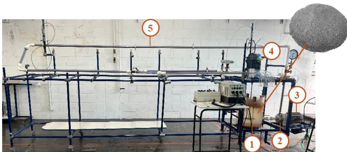
Figura 1: Unidade experimental para transporte hidráulico de minério de ferro. 1) Tanque equipado com impulsor mecânico para armazenamento e homogeneização da polpa, 2) Bomba com rotor semiaberto, 3) Motor principal para acionamento da bomba, 4) Motor secundário para acionamento do impelidor, 5) Percurso de tubulação para avaliação do escoamento. Em destaque, o pellet feed de minério de ferro.
