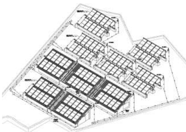
Figura 2- Local de instalação e posição dos coletores solares.
