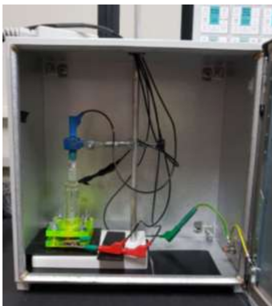
Figura 1. Aparato experimental montado dentro da gaiola de faraday: célula eletroquímica e seus eletrodos de referência, contra-eletrodo e de trabalho.
