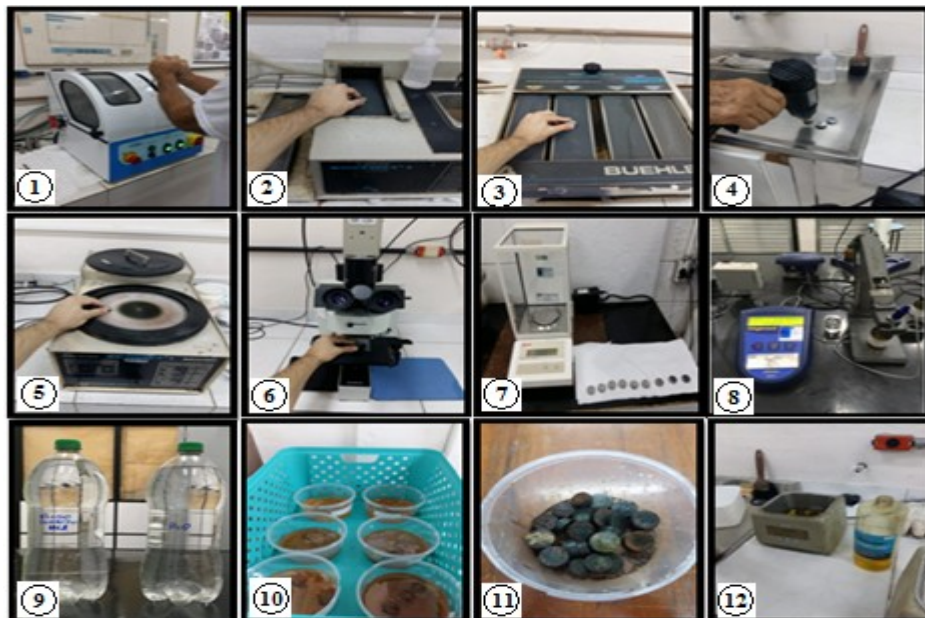
Figura 1- Preparo dos corpos de prova: 1- Máquina de corte, 2- Lixadeira de desbaste grosso, 3- Lixadeira de desbaste fino, 4- Ataque de nital/secador, 5- Máquina de polimento, 6- Microscópio, 7- Balança, 8- pHmetro, 9- Soluções de H 2 O destilada e HCl, 10- Ensaios depois de 20 dias, 11- Retirada dos corpos de prova das soluções, 12- Máquina de limpeza ultra-sônica.
