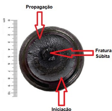
Fig. 3 - Superfície de fratura da área de maior diâmetro do eixo. Fonte: Autor
