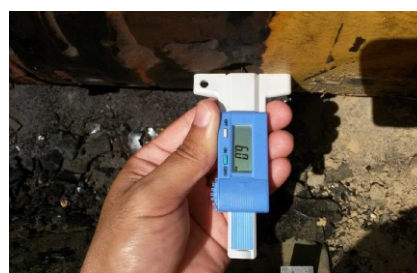
Figura 1 – Fotografias do oleoduto após abertura de vala para convalidação: a) alvéolos de corrosão na região mais crítica, b) medição da profundidade de alvéolo – 6 mm [5].
