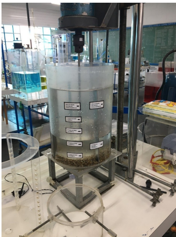
Figura 2 – Unidade piloto de tanque misturador.
