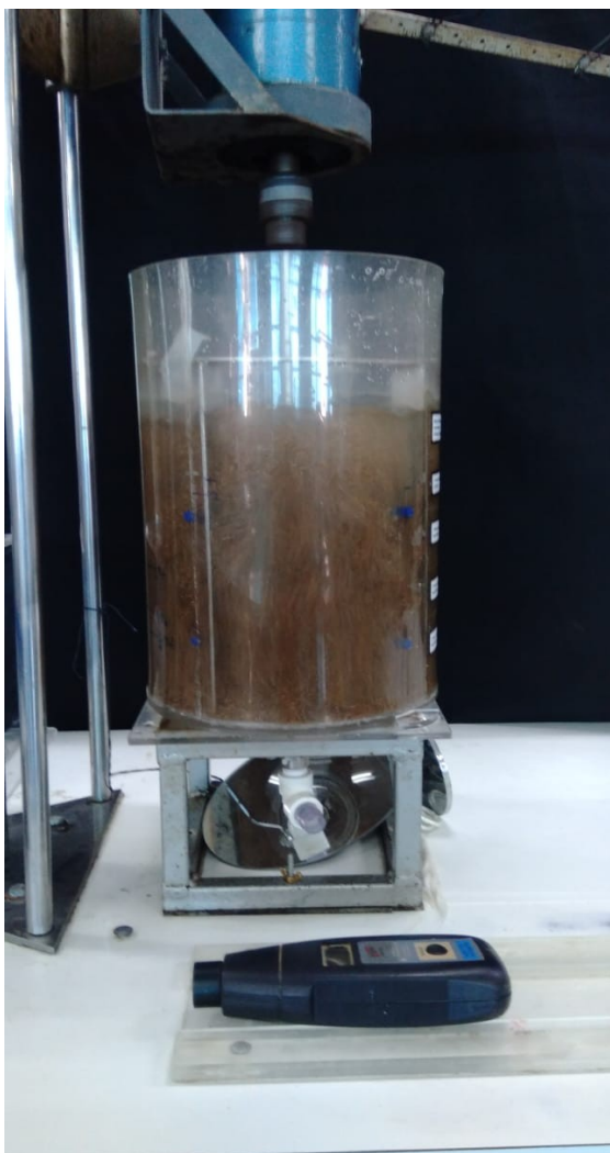
Figura 3 - Tanque de 10 litros com “draft tube” de 120 mm, impulsor a 23,5 mm do fundo do tanque com 1000 rpm.
