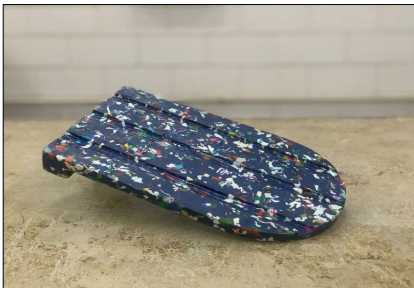
Figura 1 – Protótipo da telha feita com plástico PEAD reciclado obtido em laboratório.
