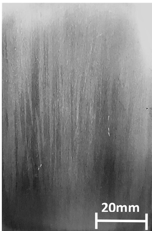
Figura 2. Macroestrutura da liga Al4Cu1Mg apresentando grãos colunares
