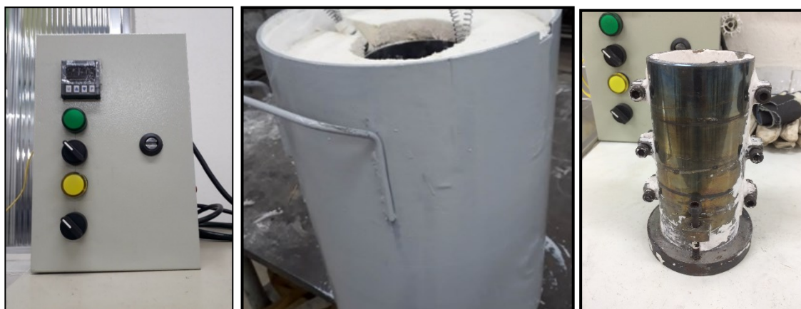
Figura 1. Controlador de temperatura, forno de resistências e lingoteira cilíndrica com molde em aço 1040 na parte inferior.
