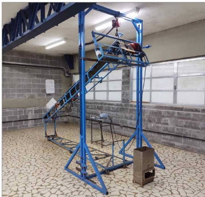
Figura 1: Sistema de correia transportadora utilizada no trabalho.
