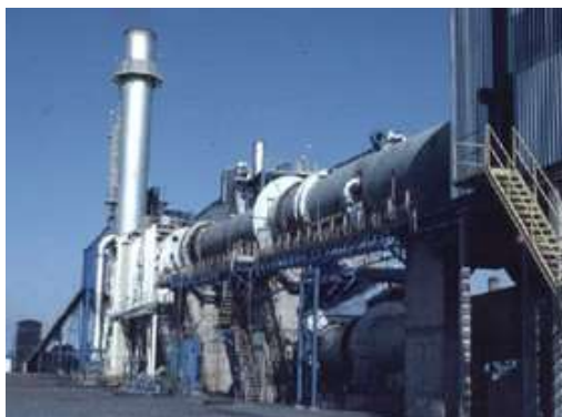
Figura 1 – Imagem de um forno rotativo utilizado na calcinação do coque verde de petróleo [4].
