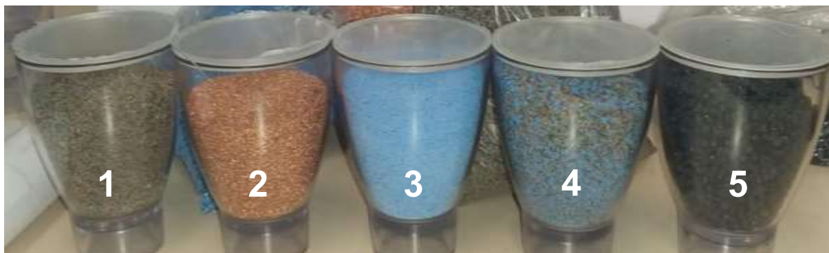
Figura 1. Materiais obtidos no processo de reciclagem de fios e cabos elétricos. 1) Material polimérico pós trituração, com cerca de 10% de cobre, 2) Cobre retirado do triturador, sem resíduos plásticos, 3) Material virgem adicionado ao PVC do pote 1, 4) Material após 1ª extrusão e 5) Material final após 2ª extrusão.
