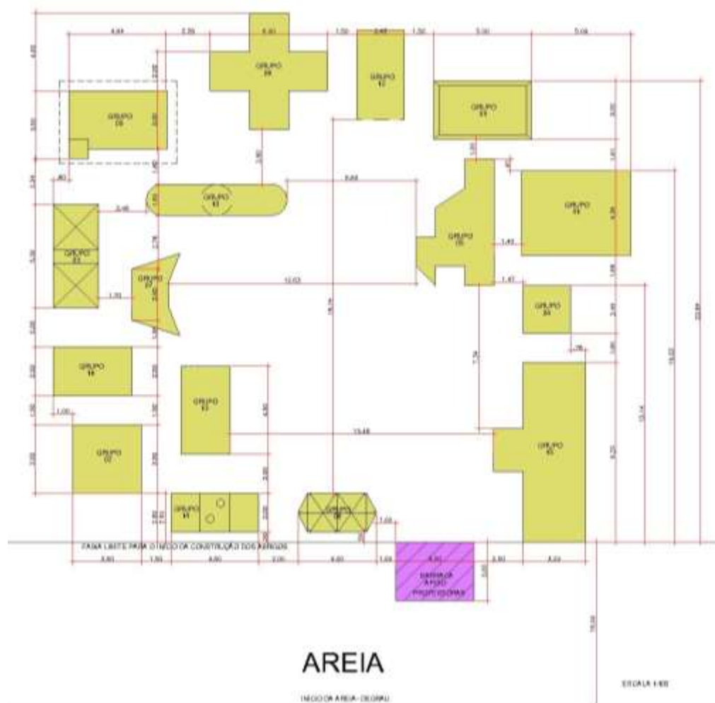
Figura 5: Desenho da Implantação dos Abrigos Provisórios
