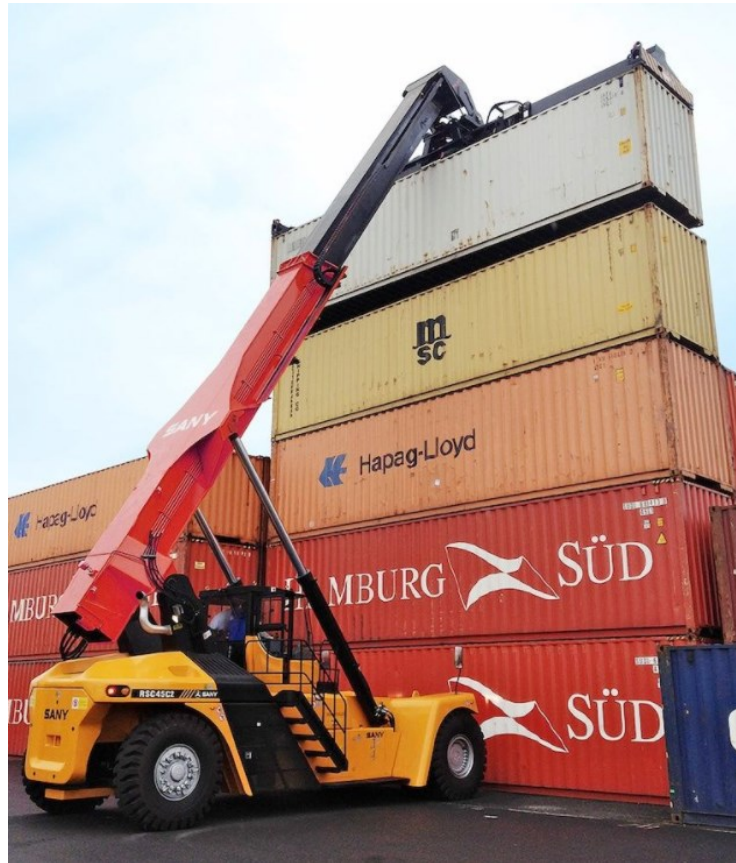
Figura 3 – Operação com Reach Stacker
