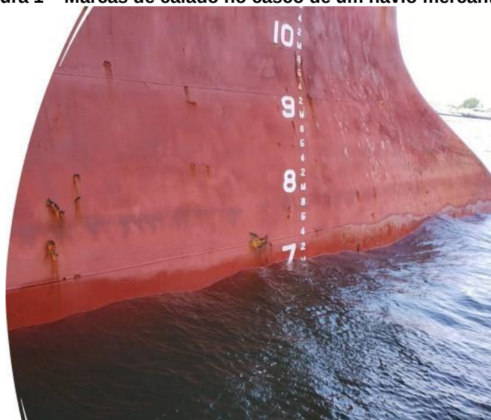
Figura 1 – Marcas de calado no casco de um navio mercante (em metros).
