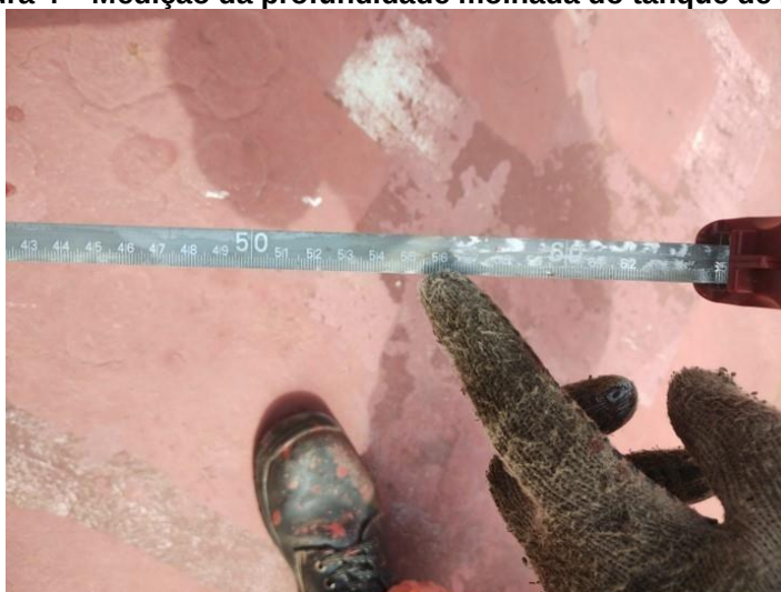
Figura 4 – Medição da profundidade molhada do tanque de lastro
