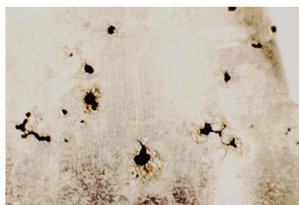
Figura 2 – Perfuração na folha de alumínio do isolamento térmico.
