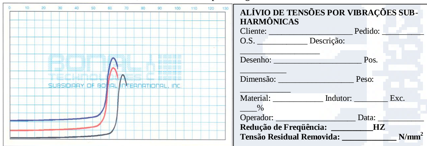
Figura 4 – Exemplo de Relatório Final do Alívio de Tensões por Vibrações Sub-Harmônicas
