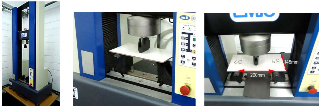
Figura 1 - Máquina de ensaios universal EMIC DL10.000 empregada no trabalho, posicionamento e dimensões das placas cerâmicas nos ensaios de flexão a três pontos.
