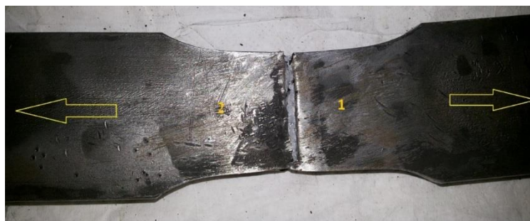
Figura 7. Aspecto do CP de tração rompido.
