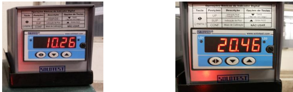
Figura 6. Registro das cargas de escoamento (à esquerda) e máxima (à direita).
