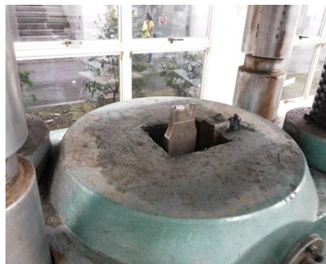
Figura 4. Fixação do CP à máquina de tração e exemplo de CP rompido.
