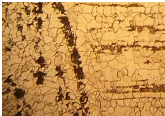
Figura 10. Aspecto metalográfico do metal base, próximo à ZTA (ataque: Nital a 2% e ampliação ótica de 50X).
