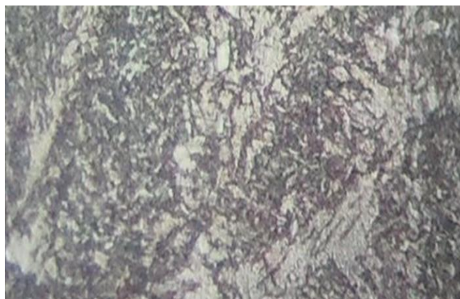
Figura 11. Aspecto metalográfico do metal depositado por solda.
