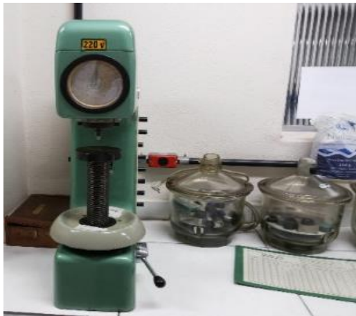
Figura 5. Durômetro laboratório UNISANTA (à esquerda) e posições das medições da dureza (à direita).
