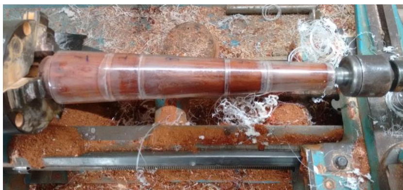
Figura 4. Construção do molde da parte inferior do hidrociclone.
