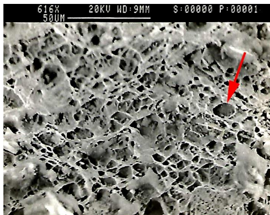
Figura 9. Fractografia microscópica da parte final da fratura, pode ser verificado a presença de cavidades hemisféricas, chamadas de dimples , característica da fratura dúctil.
