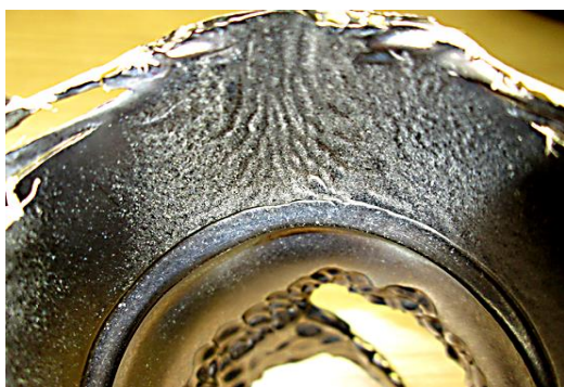
Figura 10. Resíduos na superfície do metal.
