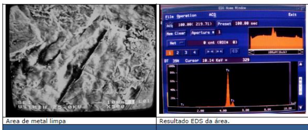
Figura 5. Região do Spray sem anormalidade e sua respectiva análise EDS.
