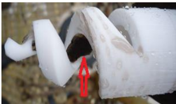
Figura 8. Spray com uma partícula de fibra de vidro.
