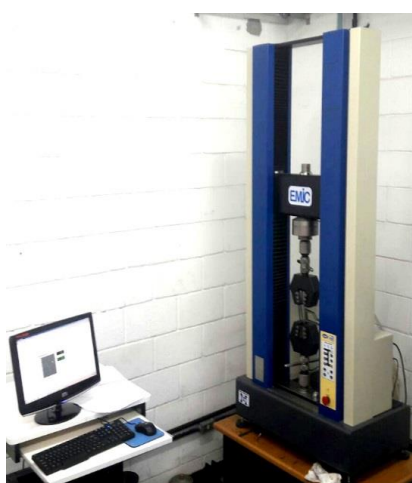
Figura 6. À esquerda: Máquina de tração EMIC DL10000. À direita: CPs soldados através dos processos SMAW e FCAW-s para ensaios mecânicos (tração e dureza).
