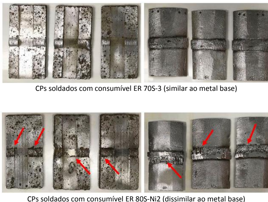
Figura 9. Aspecto dos CPs após ensaios de corrosão acelerada soldados com consumíveis similares e dissimilares ao metal base: amostras de chapa (esquerda) e tubo (direita).
