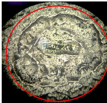
Figura 13. Dano de cavitação em uma superfície de amostra após o teste. Ampliação óptica: 50X.
