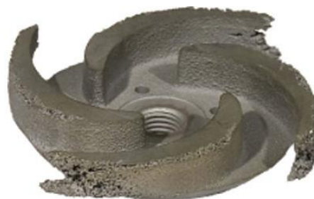
Figura 4. Impulsor após danos severos à cavitação (PRICAST, 2009).
