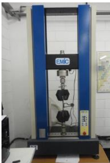
Figura 4. Máquina de Tração Eletromecânica EMIC DLC 10.000, empregada neste estudo.
