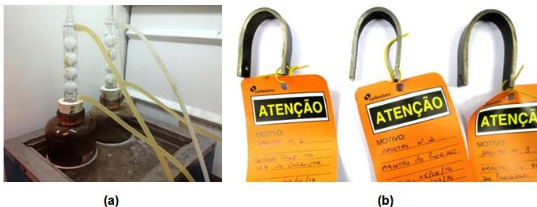
Figura 9. Realização dos ensaios de corrosão: (a) montagem experimental empregada na simulação da corrosão sob tensão e (b) o aspecto dos três CPs testados.
