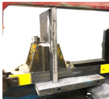
Figura 6. Corte nas amostras soldadas: (a) dimensões do corte transversal em guilhotina; (b) etapa de corte por serra alternativa e (c) peças finais com dimensões aproximadas 13×13×200 mm.
