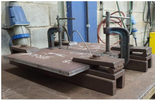
Figura 5. Visualização da condição de travamento das chapas de aço, utilizada durante todo o procedimento de soldagem até o resfriamento do conjunto.
