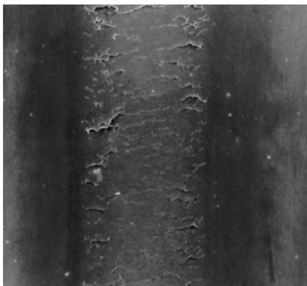
Figura 10. Desenvolvimento de micro trincas na pista de rolagem, por fadiga superficial (Fonte: Massoti, 2011).
