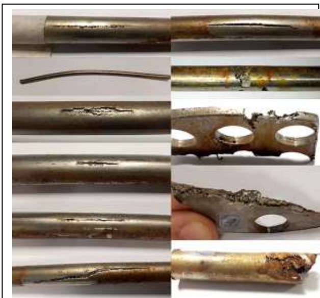
Figura 5. Amostras de tubos e chicanas danificadas.
