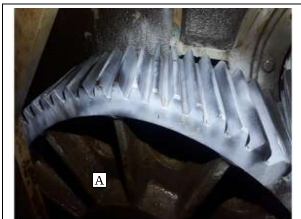
Figura 4. Exemplo da inspeção por líquidos penetrantes na engrenagem “A”.
