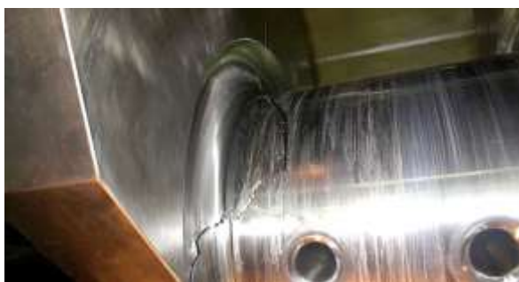
Figura 10. Fratura por fadiga do virabrequim resultado de forjamento/imperfeição metalúrgica [9].
