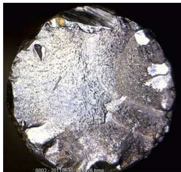
Figura 9. Face da fratura de fadiga de flexão por desalinhamento de uma válvula [8].
