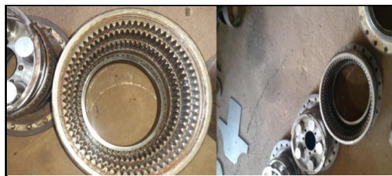
Figura 10. Engrenagens danificadas (Fonte: os autores)
