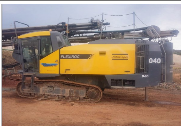
Figura 1. Perfuratriz FlexiROC D-65 Atlas Copco (Fonte: empresa em estudo).
