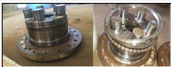
Figura 11. Eixo e porca do rolamento danificados (Fonte: os autores)
