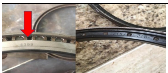
Figura 12. Rolamentos e vedações danificados (Fonte: os autores)
