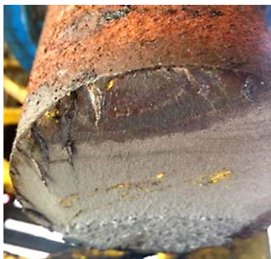
Figura 11. Registro fotográfico em detalhe da lateral da superfície de fratura do eixo indicando corrosão acentuada (parte superior), a mancha por graxa na região de início de trinca e a fratura final (região rugosa abaixo).
